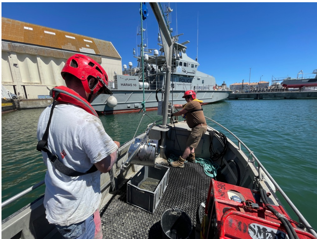
Figure 24 : Vue de la benne lors d'un prélèvement dans le bassin du commerce
