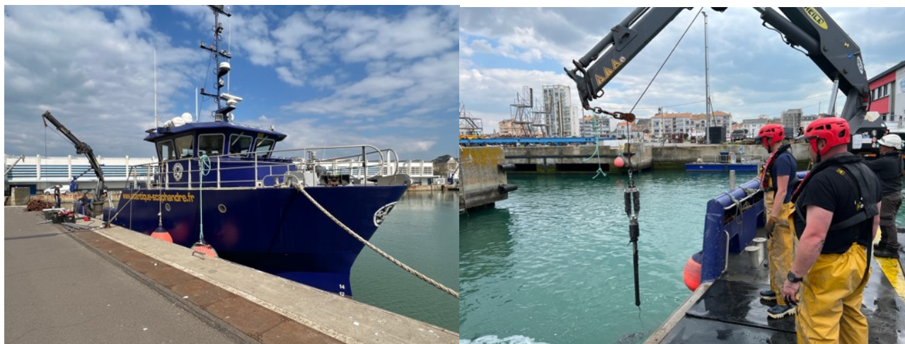
Figure 45 : Navire Miniplon d'AS et carottier gravitaire avec tube de 1 m en opération
