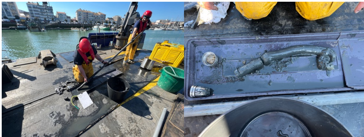
Figure 46 : Extraction d'une carotte du tube de 2 m
